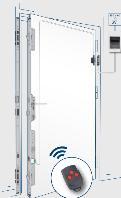
Besturingsdoos met geïntegreerde voeding voor wandmontage
